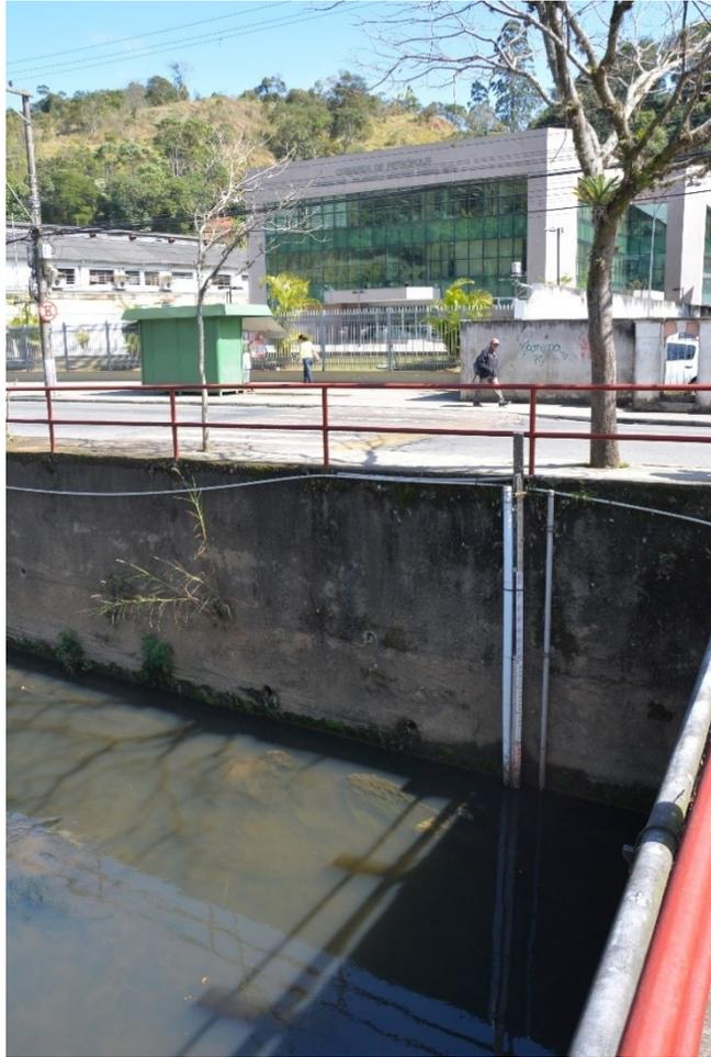
**Figura 7.** Vista da régua de nível da COPPE-UFRJ/CPRM localizada a montante do ponto 1, na margem esquerda.
