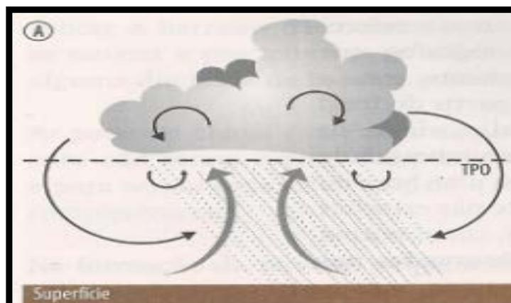
**Figura 2.2:** Esquema demonstrando um processo convectivo.
