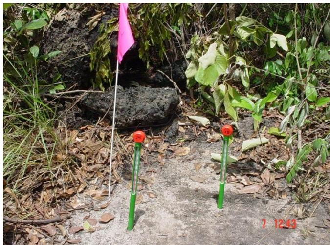
Sondas de umidade e temperatura do solo entre 0-5 cm
