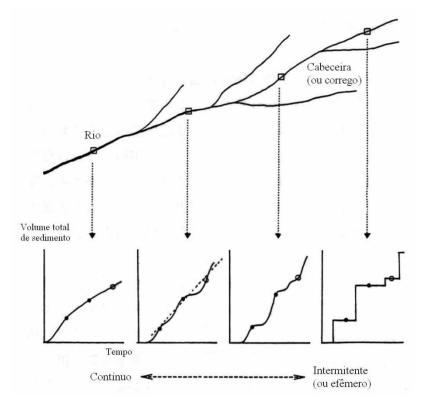
Figura 10 - Conceito de transporte de sedimentos de montante para jusante. Fonte: Kobiyama, Masato. 2003
