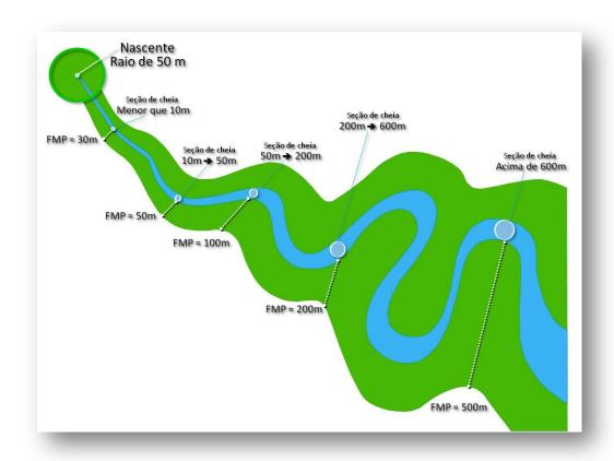
**Figura 1 - Limites das APPs em função da largura do leito regular** Fonte: Cartilha do Serviço de Demarcação de Faixa Marginal de Proteção, INEA 2010.
