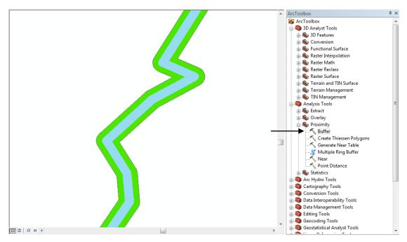
Figura 22 - Delimitação de FMP usando a ferramenta "buffer" do ArcGis
