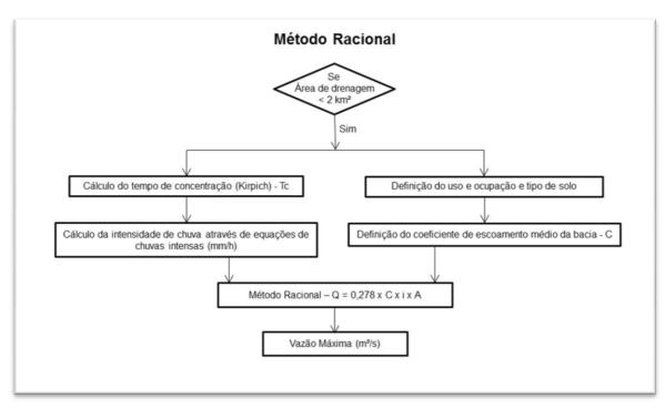
Figura 17 - Fluxograma para o cálculo da vazão máxima através do Método Racional Fonte: (INEA/HICON, 2012)
