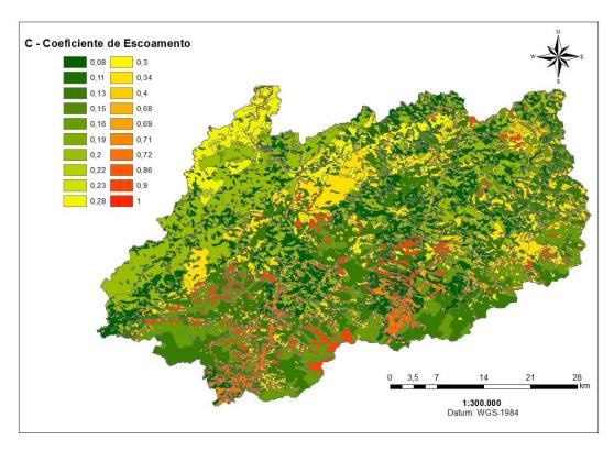
Figura 41 - Valores do Coeficiente de Escoamento (C)
