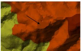
Figura 30 - TIN sem ajuste dos pontos cotados
