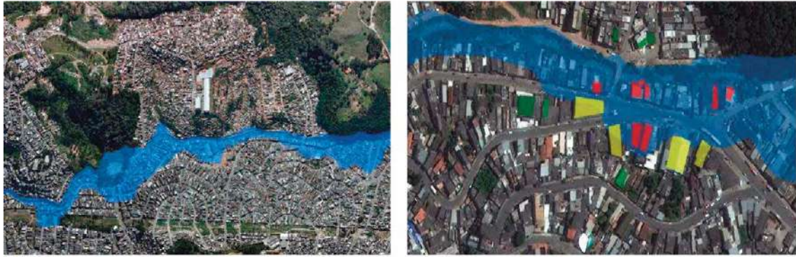
Figura 156 Linhas de inundação sobre imagem do Google Earth, com a identificação de edificações vulneráveis.
