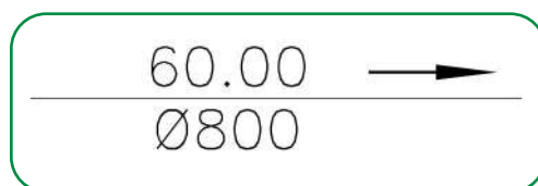
Figura 113 Representação esquemática de um trecho de rede projetada para planta geral.
