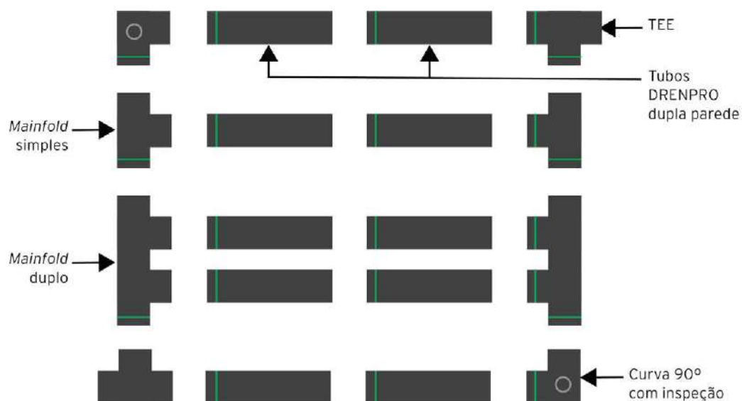
Figura 139 Montagem de reservatório de detenção com tubos de polietileno de alta densidade - PEAD.
