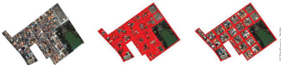
Figura 43 Mapeamento supervisionado de áreas impermeáveis amostrais. À esquerda, imagem aérea bruta; no centro, área impermeável total; à direita, área impermeável diretamente conectada à rede de drenagem.
