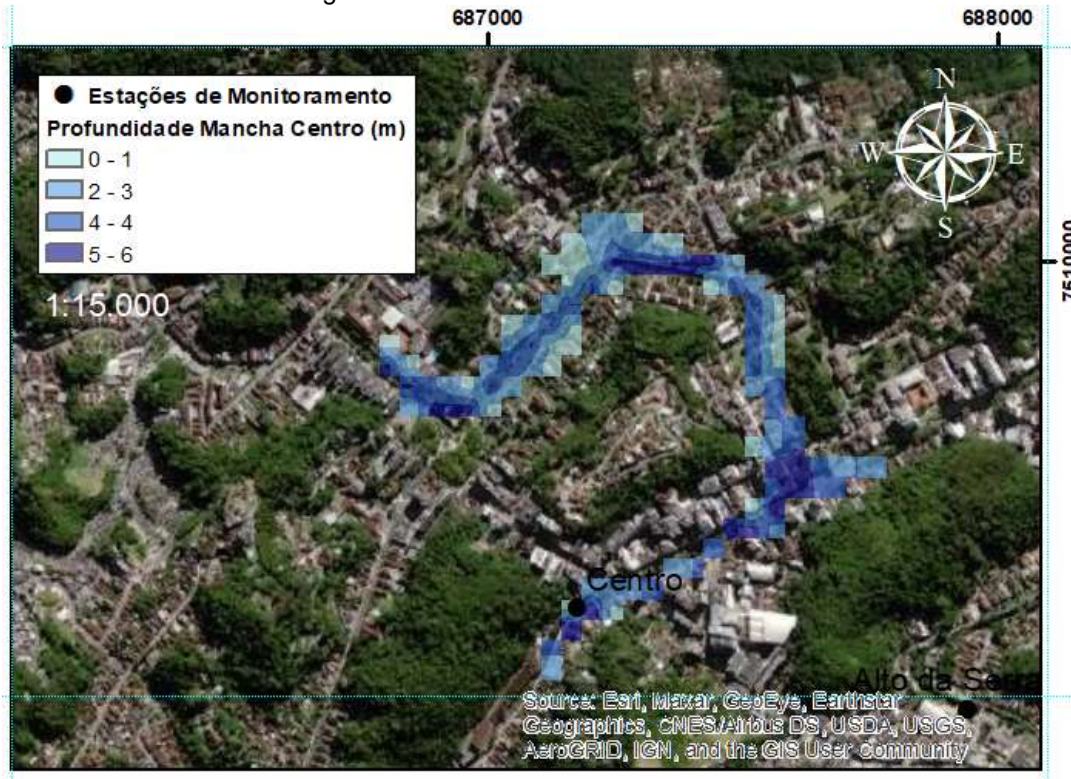
Figura 35 - Mancha de inundação com destaque na região central de Petrópolis simulado para o evento hidrometeorológico do dia 15/01/2019.
