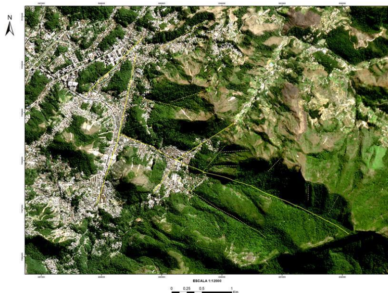
Figura 21 - Imagem de satélite com falhas e lineamentos destacados em amarelo.
