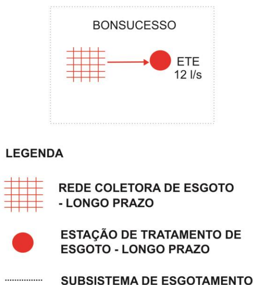
Figura 22 - Etapas de implantação do Sistema de Esgotamento Sanitário de Bonsucesso
